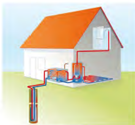
Funktionssskizze einer Wärmepumpenheizung mit Erdsonde Bild: Fotolia
